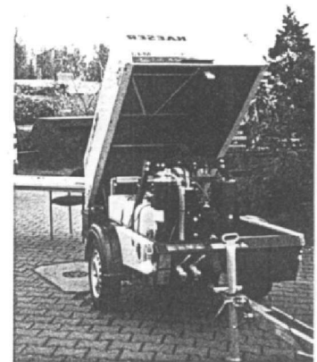
Rys. 8. Zestaw przewoźny na przyczepce do samochodu osobowego
